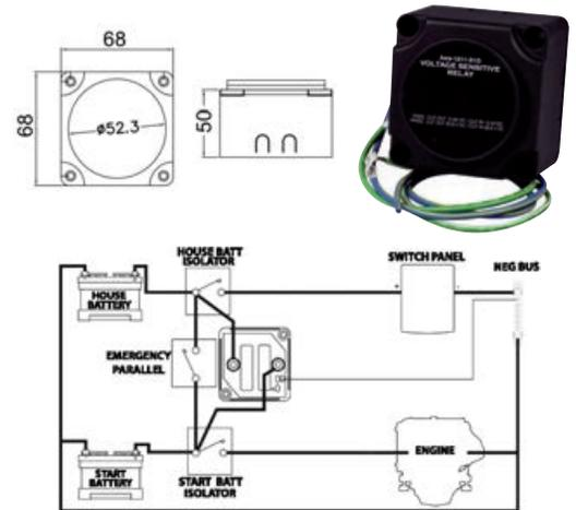
**Combinatore batterie/Relay automatico di carica intelligente bistabile LITTELFUSE®**
