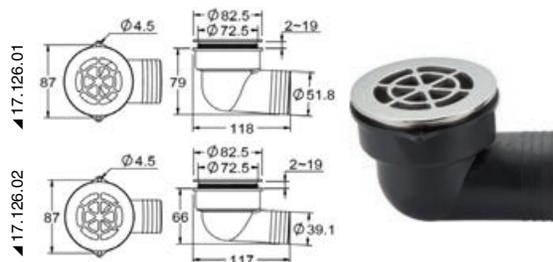
**Scarichi pozzetto a filo con testa inox**
