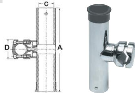
Orientabile a 360° sia orizzontalmente che verticalmente. Presenta la particolarità di avere la regolazione tramite una vite che passa attraverso il tubo porta canna, per cui **non occorre svitare il morsetto** per la regolazione. Realizzato in **acciaio inox AISI 316 microfuso e lucidato** + boccia in santoprene.
