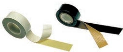
E' indispensabile per il bloccaggio di tenditori, rivestimenti di parti elettriche, finiture di impiantature, ecc. Si avvolge intorno al pezzo e il nastro si fonde formando un rivestimento uniforme.
