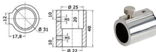
**Raccordo di collegamento per tubi rettilinei, completi di due pulsanti di fermo a molla**
