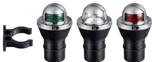
Costruiti in **ABS cromato + ABS nero**. Montaggio a scatto immediato tramite staffa in nylon. Utilizzano una pila a torcia LR20 da 1,5 volt con un'autonomia di 15/30 ore (funzionamento continuo/discontinuo). Accensione tramite rotazione parte centrale.
