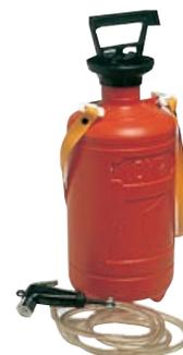
52.187.00 E' costituita da un recipiente in ABS che può contenere 8 litri d'acqua, da una doccia con rubinetto a pulsante e 1,7 metri di tubo, da un pistone pressore. Azionando 25 volte il pistone si mette in pressione fino a tre bar e l'acqua può uscire dalla doccia. La Handi Shower é ben costruita e molto funzionale.
