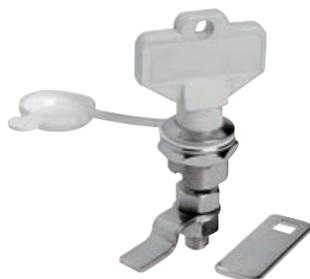
**Chiusura a tavola con chiave**In **ottone cromato**, completa di cappuccio stagno di protezione. Rotazione a 90° con molla interna anti-vibrante. Completa di chiave. Doppia levetta in dotazione.
