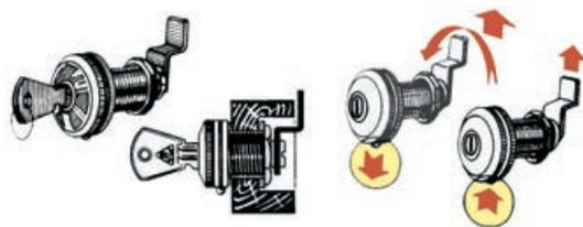
**Serratura a cilindro**Con rotazione di 90° dell'astina posteriore, si ottiene ruotando una ghiera zigrinata sotto la flangia (la rotazione è libera). Volendo **bloccare** l'astina si preme un pulsantino laterale. Lo **sblocco** si ottiene solo inserendo la chiave. Il vantaggio è che si può utilizzare la serratura sempre senza chiave. E' accessoriata con 3 astine da 16/20/25 mm per i vari spessori. E' realizzata in **ottone nichelato**, **molle compresse**.
