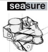
**Bozzelli per rinvio scotte avvolgifiocco VIADANA**Mantiene **all'esterno** della coperta la scotta, e facilita l'arrotolamento del fiocco, che di regola richiede sforzo elevato. Questo perché la puleggia è di **grande** diametro e montata **su sfere in delrin**.
