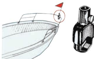
In **ottone cromato**, con fissaggio a **morsetto**. Universale per tubi con Ø mm 22/25.
