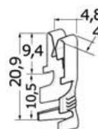
Da aggirare sui cavi e da inserire nel portafusibile (2 per ogni fusibile).
