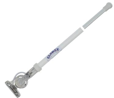
**29.996.03** Per piccole/medie imbarcazioni, completa di base acciaio inox abbattibile. Fabbricata in fibra di vetro a doppio spessore, protetta con 5 mani di vernice ai poliuretani. Guadagno 3dB, potenza entrata max 100 W, completa di 4,5 m di cavo coassiale RG58. Lunghezza 100 cm.
