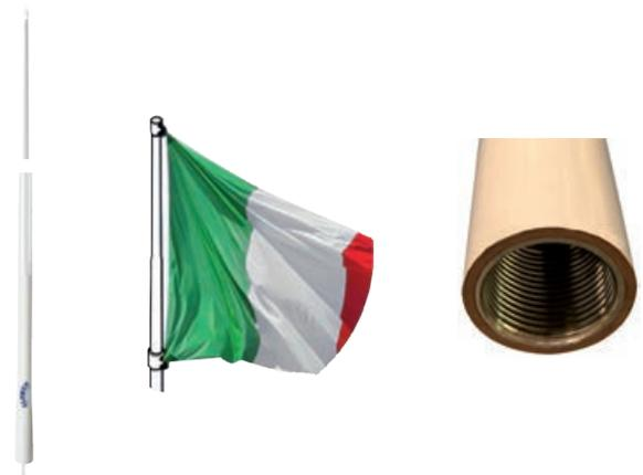
Antenna VHF dalle linee innovative con boccola integrata per essere in perfetta armonia estetica con l'imbarcazione. È dotata, inoltre, di porta bandiera alla sua estremità. Lunghezza 2,4 m. Guadagno 6 dB, potenza massima 100 W, completa di 6 m cavo coassiale RG58. Si consiglia di utilizzare la base 29.133.00.
