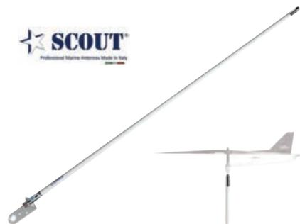
**29.312.00** Antenna VHF lunghezza 1.0 m, frequenza 156-162 MHz, potenza 50W, guadagno 3dB. Stilo in vetroresina, puntale in ottone cromato appositamente studiato per poter installare Windex 15 (35.388.02 non incluso). Permette di liberare spazio in testa d'albero installando antenna VHF e Windex nello stesso punto. Fornito con staffa in acciaio inox spessore 3 mm. Fornito con connettore tipo N femmina.
