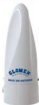
**29.996.07** Antenna VHF a basso profilo, con look uguale all'antenna TV 29.924.01. Completa di cavo RG58CU da 9 m + connettore PL259 + basetta montaggio. Guadagno 1dB, massima potenza di entrata 50 W. Polarizzazione verticale.
