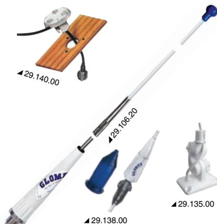
**29.106.20** In caso di rimessaggio o stivaggio dalla imbarcazione, si elimina completamente l'ingombro dell'antenna. Lunghezza 90 cm, guadagno 3db, completa di base snodata in nylon 29.135.00, cavo 4,50 m, connettore finale PL259, passacavo 29.140.00, protezione 29.138.00.
