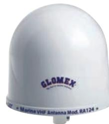
**29.996.08** Antenna VHF con look uguale all'antenna TV 29.926.50. Completa di cavo RG58 da 9 m + connettore PL259 + basetta montaggio. Guadagno 1 dB, massima potenza di entrata 50 W. Polarizzazione verticale.
