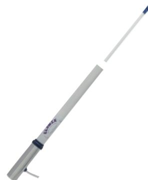
**29.996.00** In **vetroresina bianca** per radiotelefoni VHF, lunghezza 2,40 m, completa di 4,5 m di cavo coassiale RG-58 e connettore finale ottone cromato. Guadagno 6 dB. Massima potenza d'entrata 100 W. Modello particolarmente indicato per scafi a motore. Parti metalliche in **ottone cromato**. **Viene fornita senza base.**
