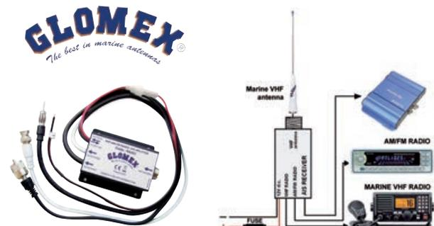
**29.448.00** Permette di ricevere le trasmissioni AM/FM/AIS (segnale identificativo natante) attraverso l'antenna VHF.
