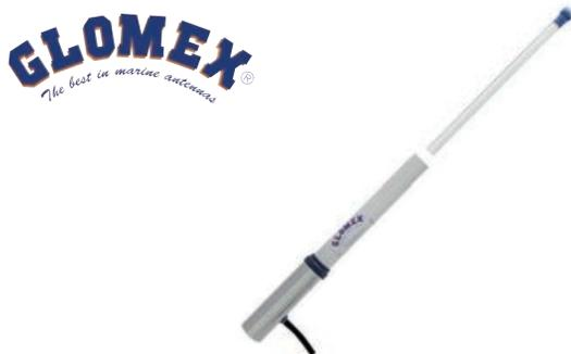
**29.128.80** Impedenza 93 Ω, di altissima qualità, lunghezza cm. 240, è stata progettata per essere abbinata alle solite antenne VHF da 2,40 metri. Utilizza tutte le basi standard in plastica, ottone cromato o acciaio inox con filetto da 1"x14. Completa di 6 metri di cavo.
